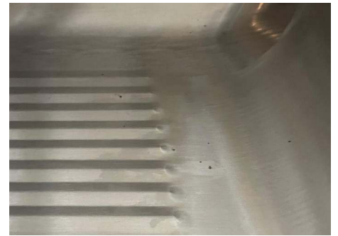
Kalk-Spritzer und liegen gebliebene Metallspäne bei V2A
