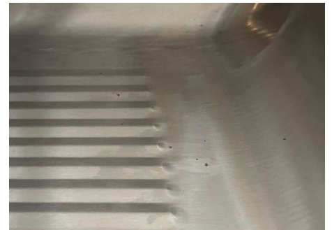
Kalk-Spritzer und liegen gebliebene Metallspäne bei V2A
