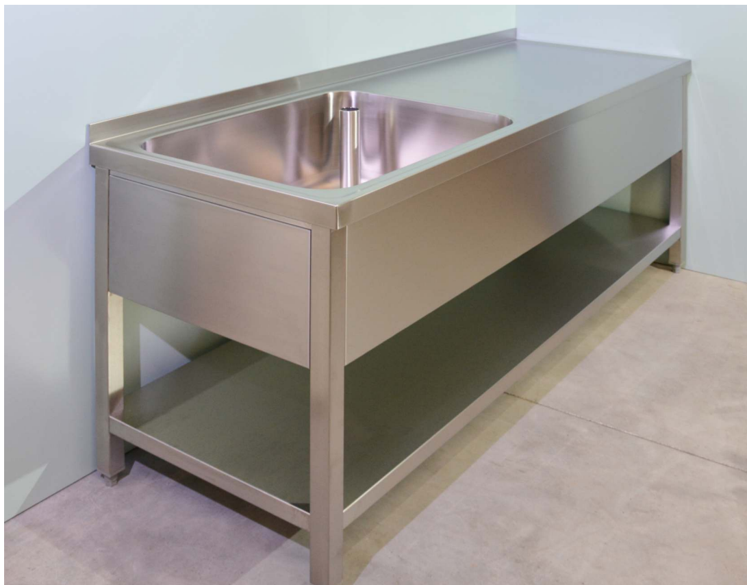
Spüle 18/10 1,2 mm, 180x60x85 cm, tiefgezogenes Becken 70x50x30links, 2" Ablaufprägung rechts, 7 mm Profilrand, 3 Lfm Beckenblende, Gestell mit Grundboden, 2" Ganzmetall-Standrohr-Ventil, unterfütterte glatte Ablagefläche, rückseitige 50 mm Aufkantung mit Kantenumschlag
