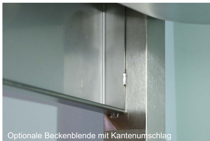
Spüle 18/10 1,2 mm, 180x60x85 cm, tiefgezogenes Becken 70x50x30links, 2" Ablaufprägung rechts, 7 mm Profilrand, 3 Lfm Beckenblende, Gestell mit Grundboden, 2" Ganzmetall-Standrohr-Ventil, unterfütterte glatte Ablagefläche, rückseitige 50 mm Aufkantung mit Kantenumschlag
