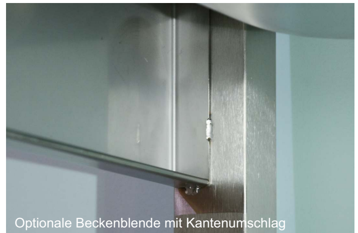
Spüle 18/10 1,2 mm, 180x60x85 cm, tiefgezogenes Becken 70x50x30links, 2" Ablaufprägung rechts, 7 mm Profilrand, 3 Lfm Beckenblende, Gestell mit Grundboden, 2" Ganzmetall-Standrohr-Ventil, unterfütterte glatte Ablagefläche, rückseitige 50 mm Aufkantung mit Kantenumschlag
