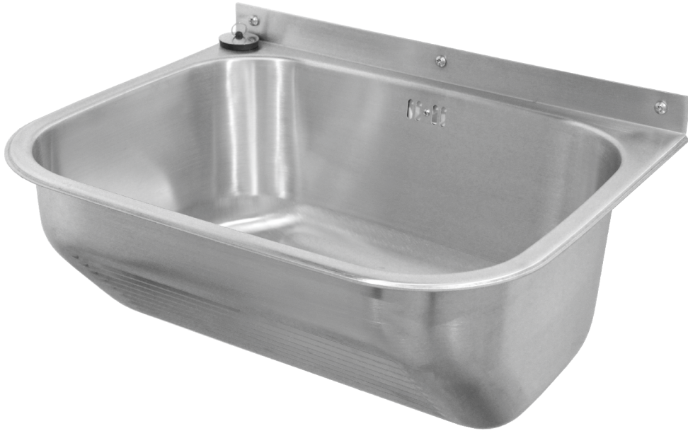
Waschtrog SOLID 550 - Profiware Aussenabmessungen: 550x450xT228 mm Becken innen: 500x400xT228 mm Gewerbespülen-Roh-Blechstärke: 1,2 mm
