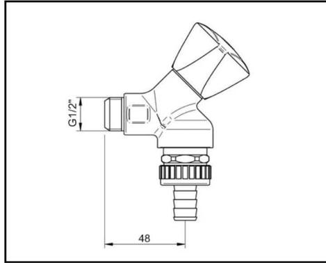
Geräteschrägsitzventil mit Rohrbelüfter
