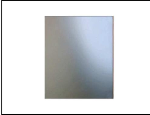
Spiegelpolierter Edelstahlspiegel 1,0 mm mit unsichtbarer Befestigung H600 x B400 x T7 mm, Spiegel allseitig abgekantet hinterfütert mit Polystyrol-Platte 6 mm Verbindung Spiegel-Platte mit Selbstklebeband Befestigung Kunststoff-Platte mit A2 Senkkopfschrauben 3,5x35 mm und Fischer Dübel UX5x30 Toleranz +/- 1,5 mm Gratfreie Krankenhaus-Qualität Einzelverpackung in doppelwandigem Karton Made in Germany
